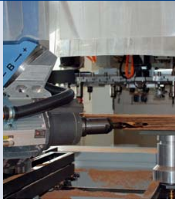
Kompakt in den Maßen und doch präzise und leistungsstark, verrichtet das 5-Achs-Aggregat seine Arbeit
