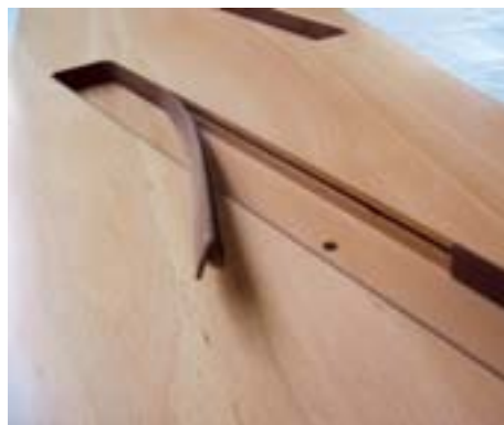
... wird in die zuvor mit der Handoberfräse eingebrachte Nut gedrückt
