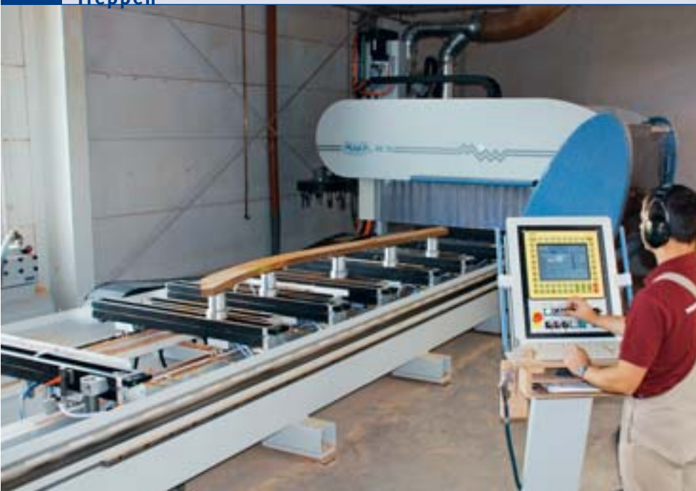
Seit Frühjahr bei Schmidt im Einsatz ist das neue 5-Achs-Bearbeitungszentrum in Gantry-Bauweise PE 70 von Maka mit einer Bearbeitungslänge von 5900 mm (BM-Fotos: Christian Nördemann)
