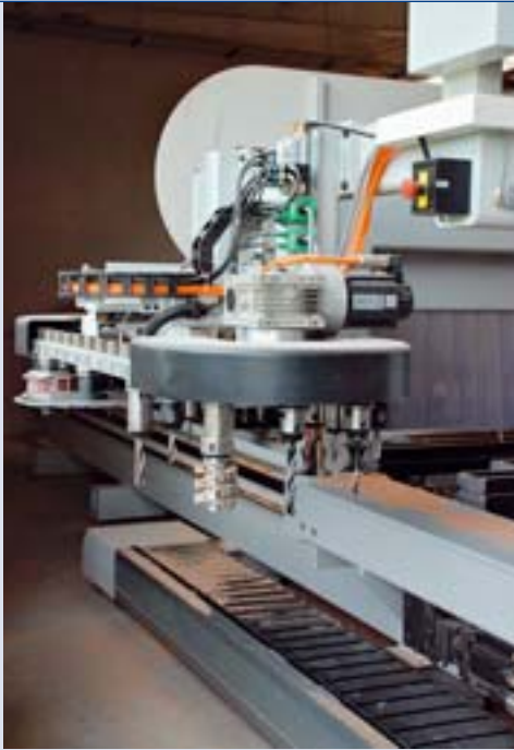
Das horizontal angebaute Kettenwerkzeugmagazin bietet Platz für 32 Werkzeuge
