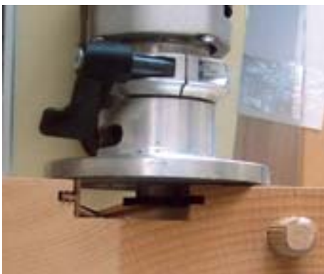
Verhindert Treppenknarren: Das von Schmidt entwickelte Elpo-Profil ...
