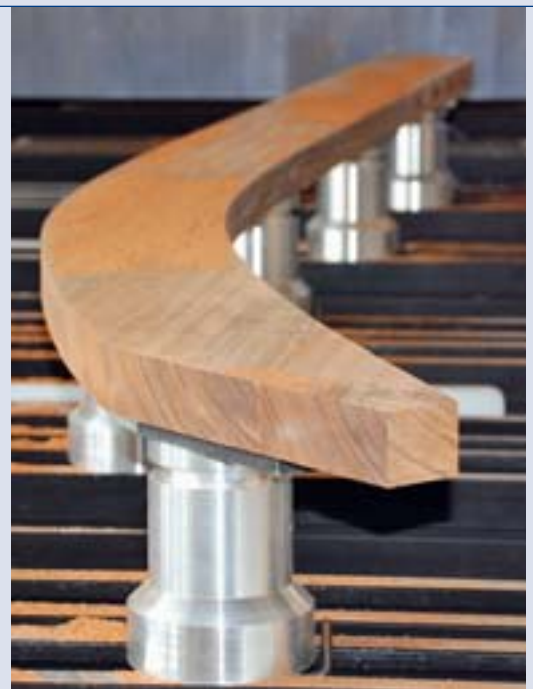
Ein Laserprojektor ermöglicht das sehr exakte und sichere Aufspannen beliebig geformter Einzelteile
