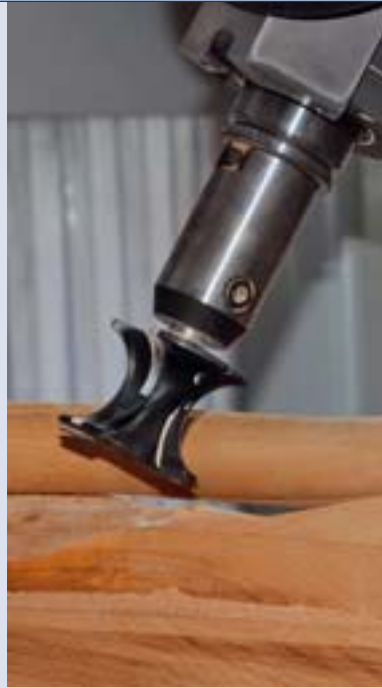
Vorteilhaft beim Krümmlingsfräsen ist der große Arbeitsbereich in Z-Richtung
